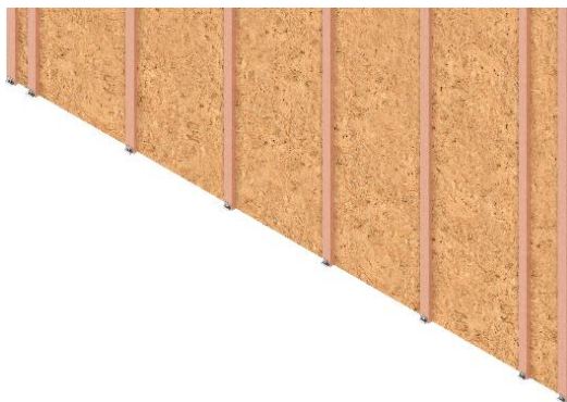
Clipreihe zwischen zwei Dielen auf der Unterkonstruktion
