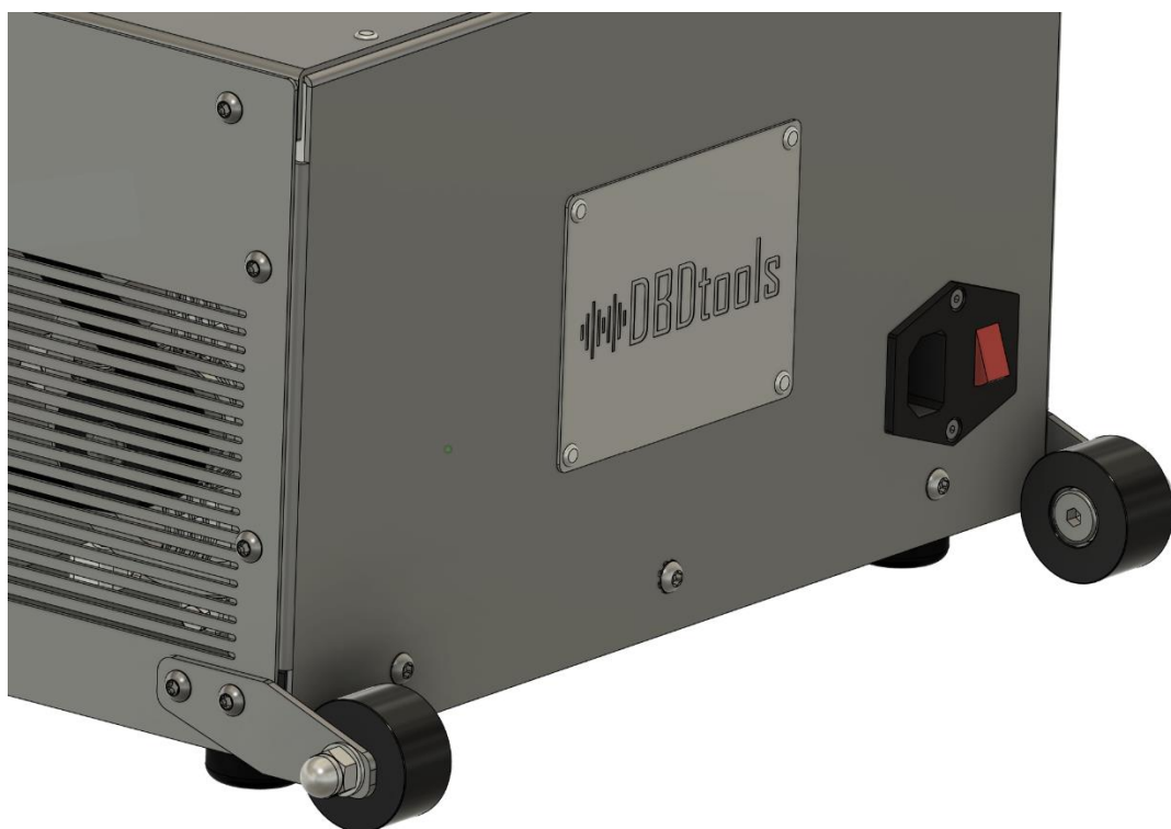
Figura 3: Instala las ruedas de transporte usando una llave T25. Observa la orientación correcta: las ruedas izquierda y derecha son diferentes.
