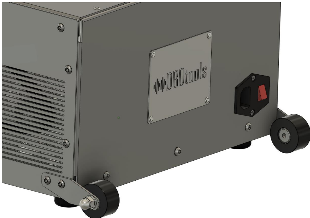
Figure 3: Installez les roues de transport avec une clé T25. Respectez l'orientation correcte – les roues gauche et droite sont différentes.
