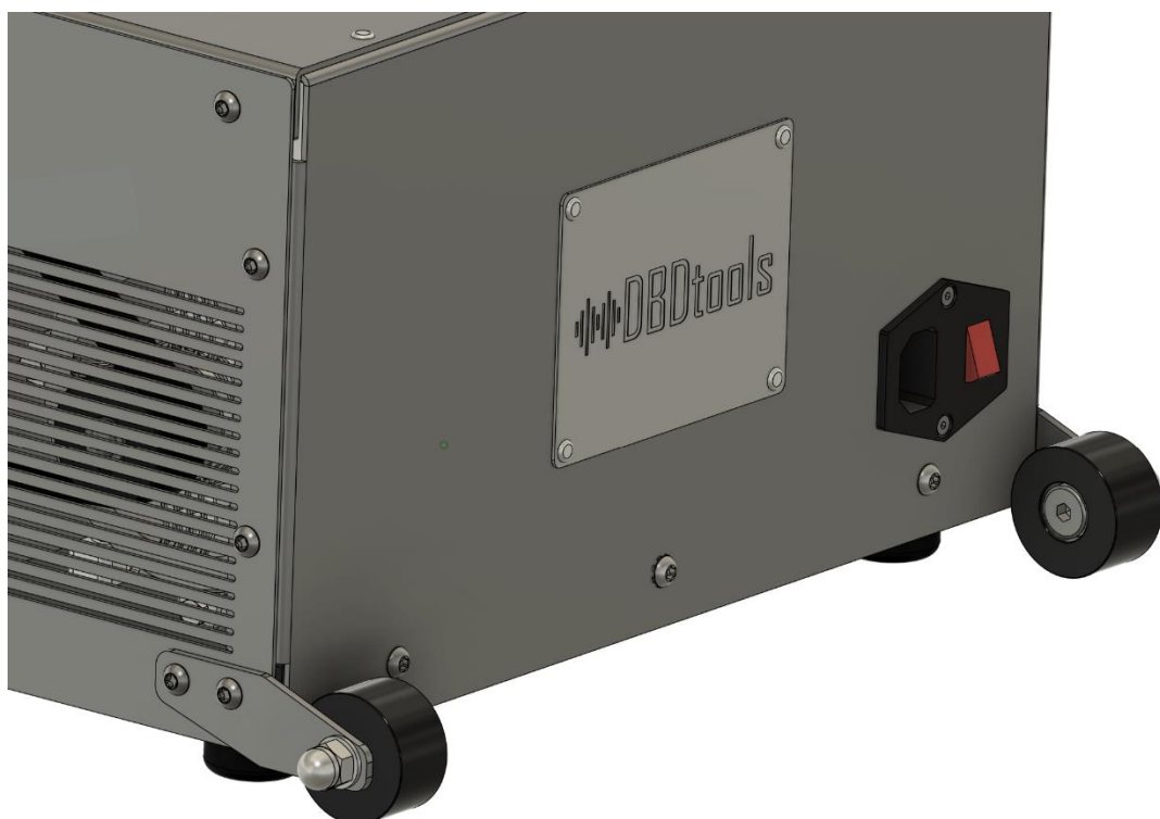
Figuur 3: Installeer de transportwielen met een T25-sleutel. Let op de juiste oriëntatie - linker- en rechterwielen zijn verschillend.
