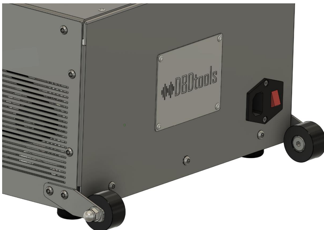
Figura 3: Installa le ruote di trasporto usando una chiave T25. Osserva l'orientamento corretto: le ruote sinistra e destra sono diverse.
