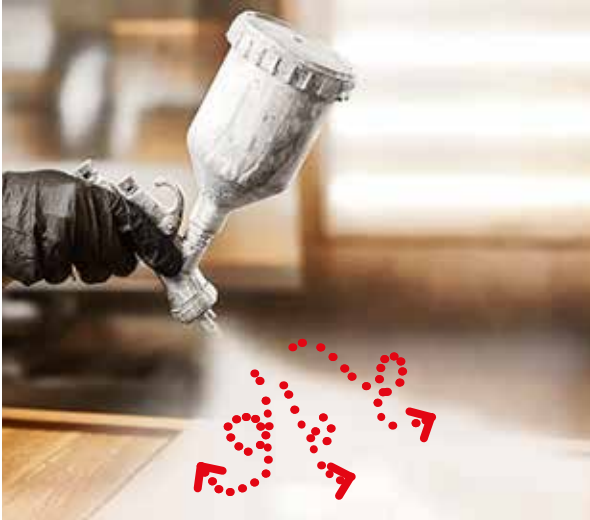
SISTEMAS DE PINTURA ACTUALES EFFECTO REBOTE ◦ "OVERSPRAY"
