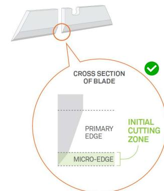
La hoja de acero tradicional se desafila rápidamente debido a la suavidad del material y al ángulo agudo necesario para ser "afilada"
