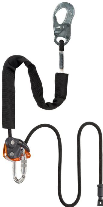
Cordino polivalente para trabajos en altura. Certificado para usos como cordino para trabajos de posicionamiento regulable EN 358, anclaje provisional EN 795-B y línea de vida horizontal EN 795-C / TS 16415-C. El dispositivo es acorde a todo lo pedido por la norma EN 12841-C para utilizarlo como descensor a excepción de los puntos 4.1.2 y 4.1.3 que no se han considerado\*.
