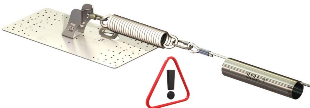
Una volta terminata la procedura di tensionamento della fune, spostare i tubolari di rivestimento sopra gli assorbitori di energia.
