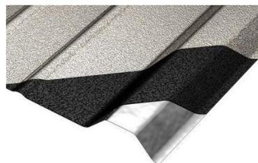
Le lamiere tipo coverib\* hanno una base bituminosa di circa 1,5 mm che aumenta lo spessore serrabile, (SS della scheda tecnica pag. 43) rendendo necessario l'utilizzo di un rivetto di lunghezza superiore.
