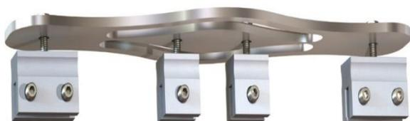
Dopo aver allentato mediante una chiave a brugola CH 5 i grani M10 presenti sui morsetti in Alluminio, inserire il dispositivo precedentemente assemblato sul risvolto della lamiera aggraffata.
