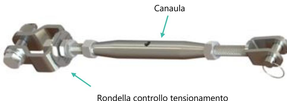
La procedura di tensionamento ha termine quando la rondella di controllo tensionamento gira mediante una lieve pressione manuale; ciò segnala che il sistema è tensionato correttamente a circa 0.8kN (80 kg) e che la procedura di tensionamento va arrestata. Mandare in battuta i due dadi M12 alla canala e serrare.
