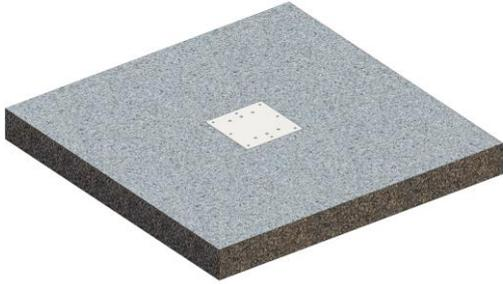
1. Appoggiare la piastra di base sulla struttura di supporto e posizionarla correttamente in modo da procedere con la tracciatura dei fori necessari al suo fissaggio;
