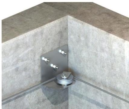
Per realizzare una curva interna a parete, si rende necessario l'utilizzo del supporto per modulo ad angolo interno TNX-03-0011; unire i due elementi mediante la V.T.E. M12x70, la rondella ed il dado autobloccante presenti nell'articolo TNX-03-0001.
