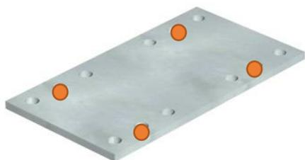
Fare aderire la contropiastra all'intradosso della struttura; appoggiare il palo sull'estradosso della struttura di supporto e mediante 4 barre filettate M12x350 comprese nel codice unire la contropiastra al palo e serrare la bulloneria.
