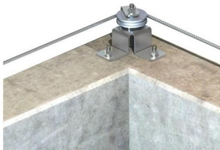
Per realizzare una curva interna/esterna a pavimento si rende necessario l'utilizzo del supporto per modulo ad angolo superiore TNX-03-0031; unire i due elementi mediante la barra filettata M12x250, la rondella ed il dado autobloccante presenti nell'articolo TNX-03-0001.
