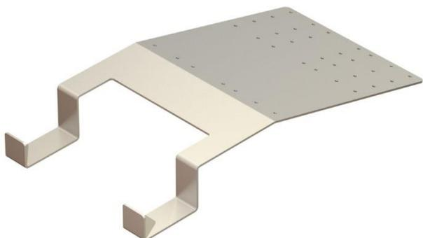
Questo elemento non richiede nessun assemblaggio; deve essere posizionato direttamente sulla copertura metallica ed installato mediante 2 file di 5 rivetti  $\varnothing$  5,2 mm inseriti nella greca del pannello/lamiera di copertura.
