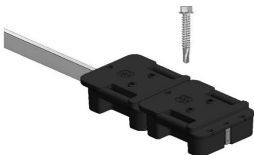
Inserire infine la vite  $\varnothing 4,8 \times 50$  mm per collegare le zavorre al piede in alluminio.
