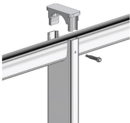
Inserire il corrimano all'interno dell'idonea sede ricavata nel montante, innestare il tappo e serrare mediante la vite  $\varnothing 4,8 \times 25$  mm.
