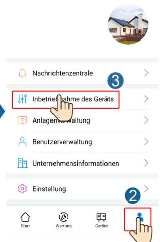
2. Stellen Sie eine Verbindung zum WLAN des Solarwechselrichters her und melden Sie sich als **Installateur** an, um auf den Bildschirm „Inbetriebnahme des Geräts“ zuzugreifen.
