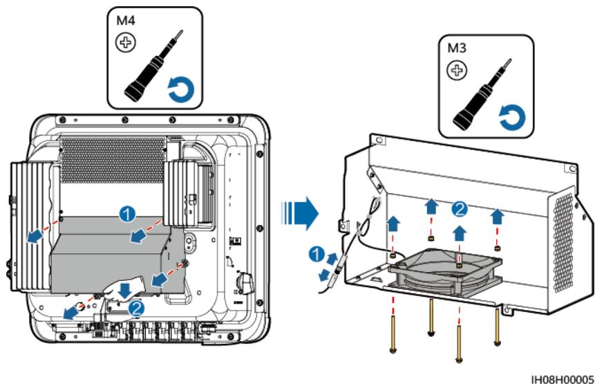
**Schritt 3** Bauen Sie einen neuen Lüfter ein, schließen Sie die Kabel an und befestigen Sie die Lüfterabdeckung.
