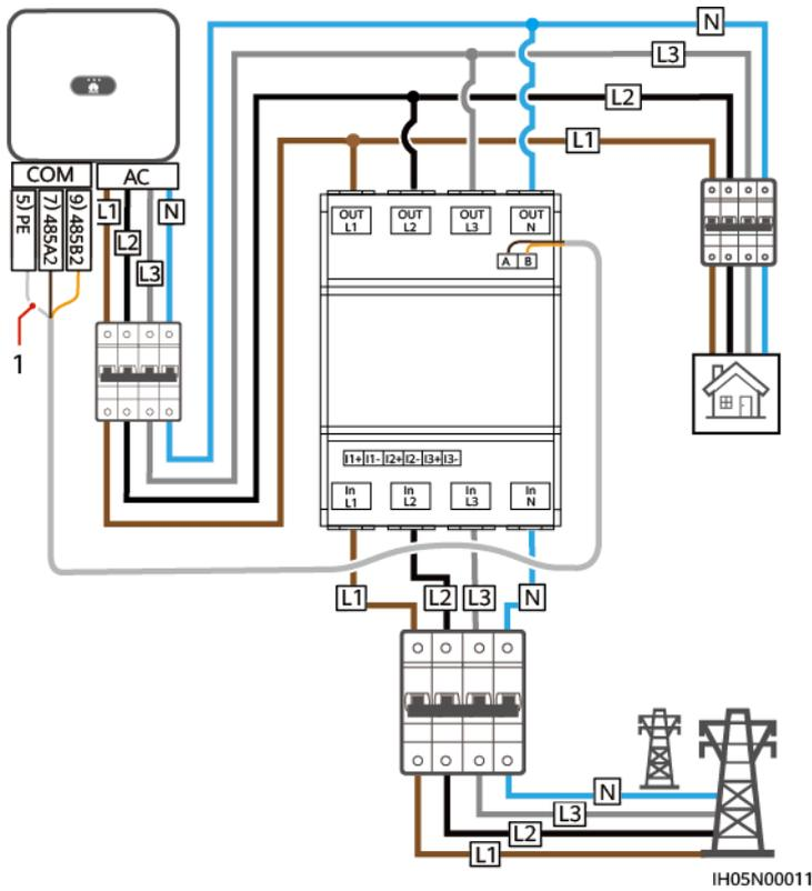
Abbildung 5-28 Dreiphasige dreiadrige Direktverbindung (SmartLogger-Vernetzung)
