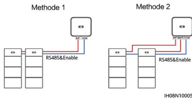
Der Anschluss des Wechselrichters an vier Batterien ist in der folgenden Abbildung dargestellt.
