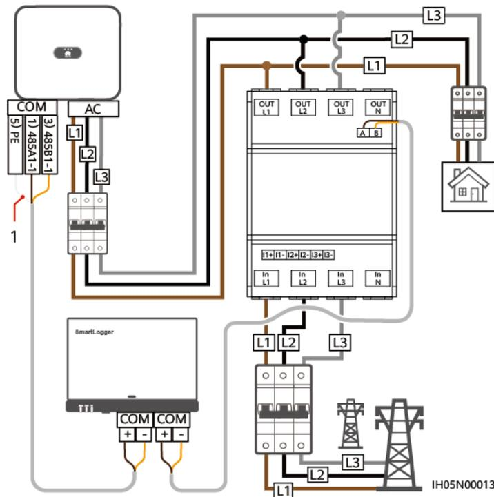
Abbildung 5-29 Dreiphasige vieradrige Direktverbindung (SmartLogger-Vernetzung)
