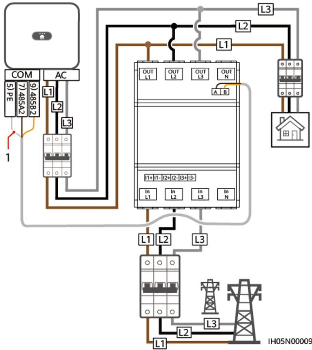
Abbildung 5-27 Dreiphasige vieradrige Direktverbindung (Smart Dongle-Vernetzung)
