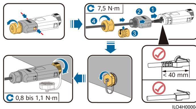
Abbildung 5-50 Installation der Anti-Diebstahl-Komponenten für den Smart Dongle
