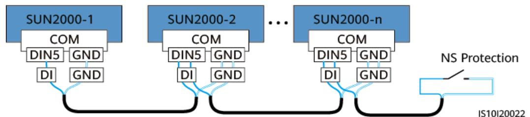
**Schritt 1** Verbinden Sie die Signalkabel mit dem Signalkabelsteckverbinder (für Kaskadierung der Wechselrichter).
