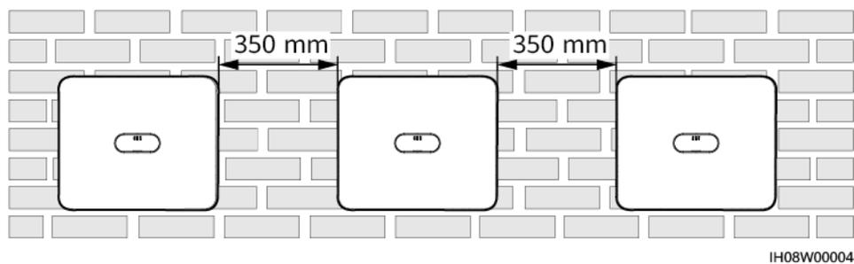
Abbildung 4-4 Dreiecks-Installationsmodus (empfohlen)
