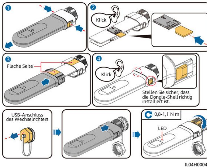
Abbildung 5-52 Installation der Anti-Diebstahl-Komponenten für den Smart Dongle
