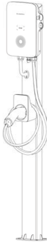
Abbildung 2-8 An einer Säule montierte Ladestation
