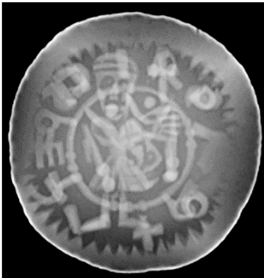
Obr. 3: Rentgenografický snímek mince s viditelným průmětem reliéfu na aversu i reversu mince.
