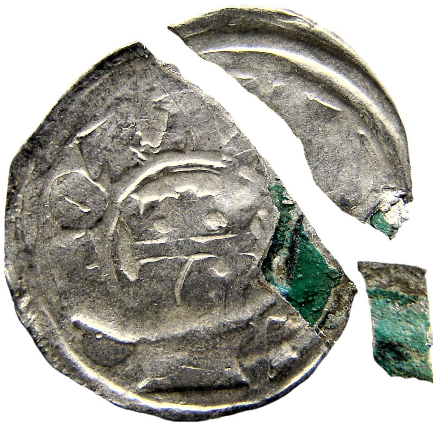
Obr. 4: Fotografie stříbrné mince se zjevnou delaminací povrchu s korozními produkty mědi pod povrchovou vrstvou bohatou na stříbro.
