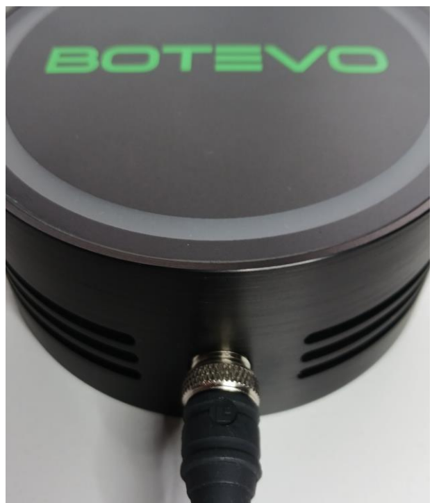
Abbildung 2.3.2: Der verbundene Anschlussstecker für den BOTEVO GUARD.
