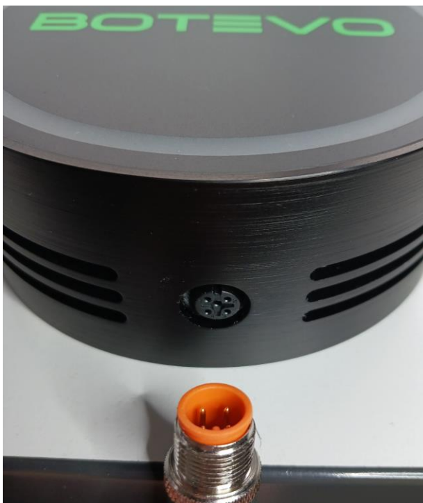
Abbildung 2.3.1: Der Anschlussstecker für den BOTEVO GUARD.
