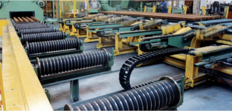
Beschickung vor einer Strahlanlage für Vierkant- und Sechskantstangen sowie Flachmaterial Feeding system in front of shot-blasting equipment for square and hexagon bars as well as flat material
