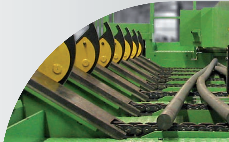
Stangenvereinzelung für schwarze Rundstangen Separation system for round black bars
