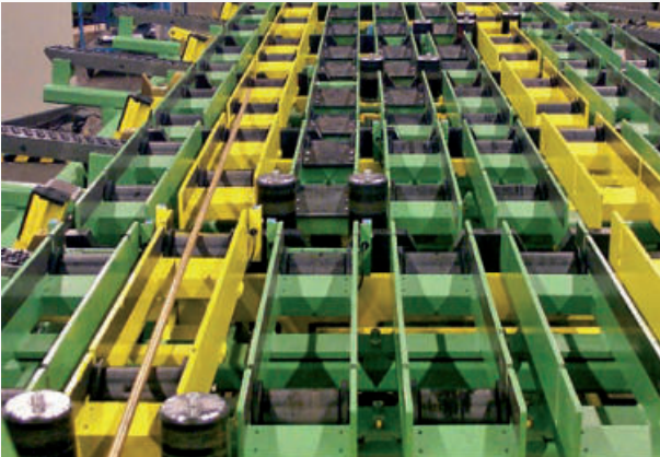
Fasanlage für Vierkant-, Sechskant- und Rundstangen aus Messing Chamfering line for square, hexagon and round bars made of brass
