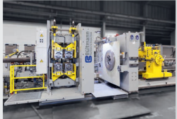
Schälmaschine für hochfeste Stahlstangen bis \varnothing 160 mm Peeling machine for high-strength steel bars up to \varnothing 160 mm
