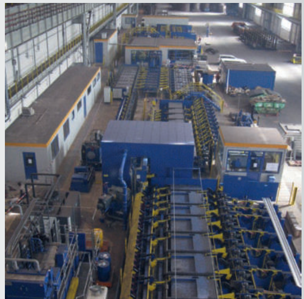
Schlüsselfertige Blankstahllinie für hochfeste Stahlstangen Turnkey bright bar production line for high-tensile steel bars
