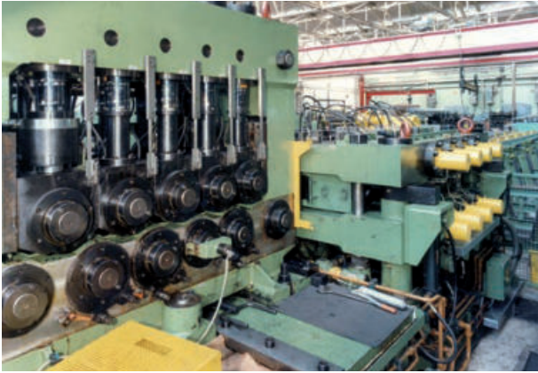
2 x 11-Rollen-Richtmaschine für Stahlstangen 2 x 11-roll straightening machine for steel bars
