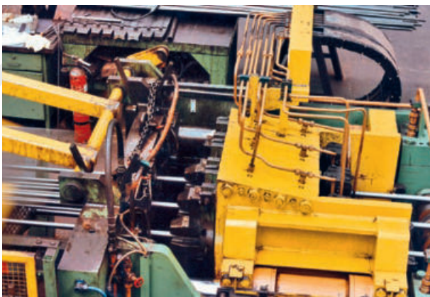
3-fach-Einschubvorrichtung für Rund-, Sechskant- und Vierkantstangen sowie Flachmaterial aus Stahl; kein Backenwechsel bei Dimensionswechsel erforderlich Triple push-in device for rounds, hexagons, squares and flat steel; no need to change the jaws when changing-over to another dimension
