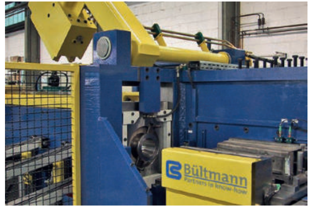
1-fach-Stangenziehmaschine für Supraleitermaterial mit Einschubvorrichtung Single bar drawing machine with push-in device for superconducting material
