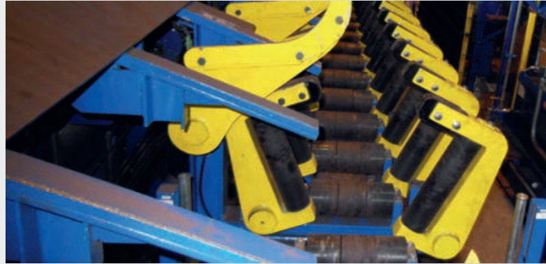
Einlaufbahn für rundes Schwarzmaterial Entry channel for black rounds
