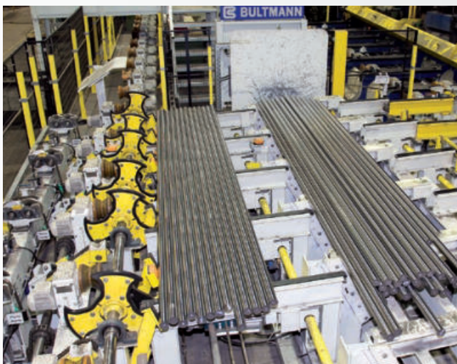
Einlauf zu einer Wirbelstromprüfanlage für runde Stahlstangen Entry side of an Eddy current testing unit for round steel bars
