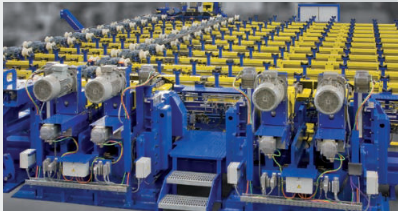
Fasanlage für Stahlstangen Chamfering line for steel bars
