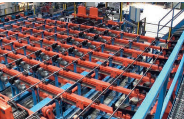
Hochproduktive Blankstahladjustage für Stahlstangen High-performance bright bar finishing line for steel bars
