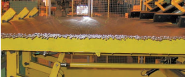
Vereinzelung und Lagenbildung vor einem Glühofen Separation system and layer forming in front of an annealing furnace
