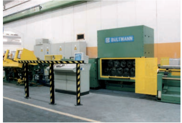
2 x 10-Rollen-Richtmaschine für Messingstangen und -profile 2 x 10-roll straightening machine for brass bars and profiles
