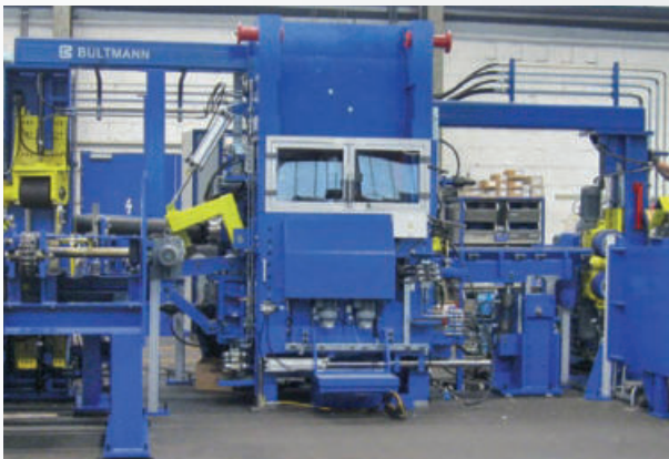
2-Walzen-Richtmaschine für geschälte Stangen 2-roll straightening machine for peeled bars
