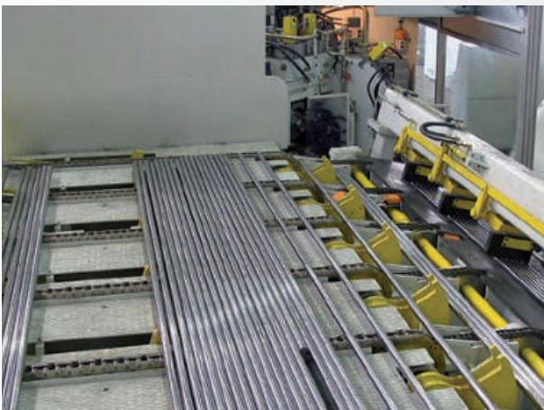
Stangenvereinzelung vor einer Richtmaschine Bar separation system in front of a straightening machine
