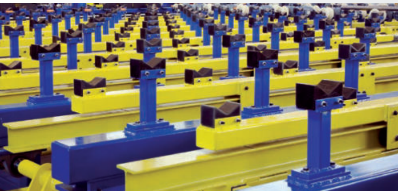
Hubbalkenquertransport einer Fasanlage für Stahlstangen Walking beam cross transport on a chamfering line for steel bars
