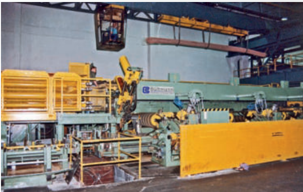
3-fach-Stangenziehmaschine mit Sägeanlage für Messingstangen und -profile Triple drawing machine with sawing unit for brass bars and profiles
