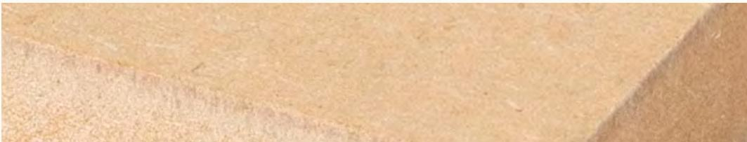
**MDF** - Wir verwenden MDF, da es einen hohen Rezyklatanteil hat und sich leicht mechanisch bearbeiten lässt. Es bietet die Grundlage für die Lackierung in Cl-Farbe. Das Volumen ist hohl, um so Material zu reduzieren. Durch Gewindemuffen lässt sich das Volumen vom Gestell trennen.
