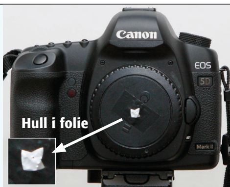
DSLR som hullkamera. Detaljforstørrelsen t.v. viser hullet som i stedet for et objektiv samler lysstrålene.
