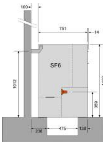
Anlegg av lav type installert over kabelgrøft
