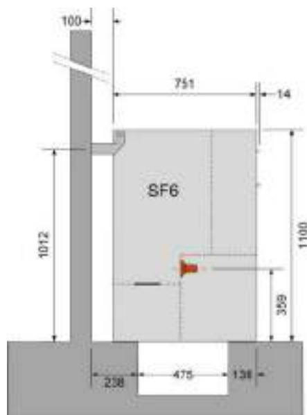
Anlegg av lav type installert over kabelgrøft
