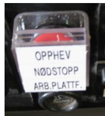
Bryter for utkopling av nødstopp i arbeidsplattform
