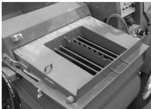
Figur 21: Blanderdeksel med støvavsug
