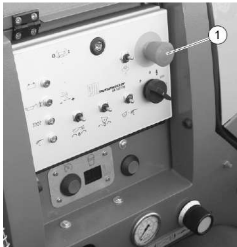
Figur 41: Plassering av NØDSTOPP-knappen
