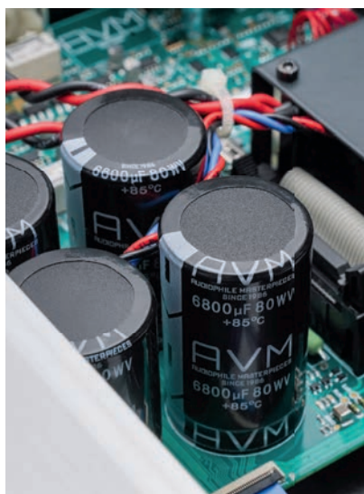
Klangentscheidende Elkos lässt sich AVM nach strengsten Spezifikationen mit eigenem Logo fertigen.
