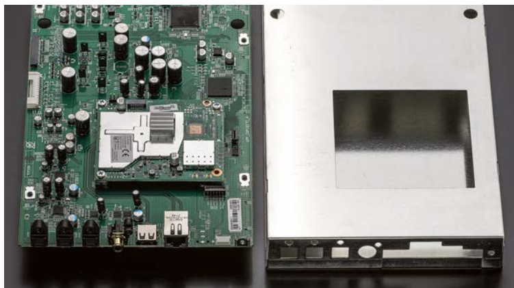
Der Digitalteil wird sorgfältig abgeschirmt, um den störungsanfälligen, analogen Schaltungsteil nicht zu beeinträchtigen.
