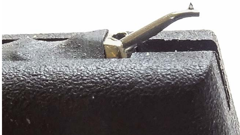
Auf dem Aluminiumnadelträger sitzt ein Diamant mit scharfem „Gyger II“-Schliff. Eine Abdeckfolie verhindert das Eindringen von Schmutz und Staub.
