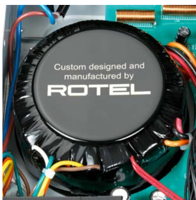
Das Familienunternehmen Rotel fertigt die klanglich wichtigen Ringkerntransformatoren seit jeher im eigenen Werk.
