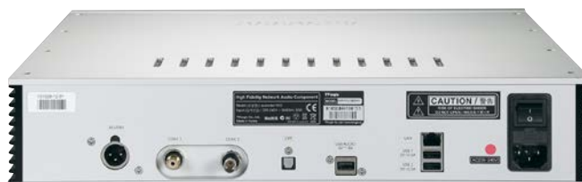
Die aufgeräumte Rückseite des N10 bietet fünf digitale Outputs (l.) plus LAN-Buchse und zwei USB-Ports (r.) für externe Sticks und Festplatten.
