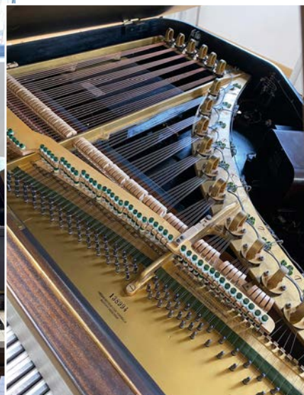
Beim „Neo-Bechstein“ aus dem Jahr 1932 verstärken elektrische Röhren den Klang, der dann über eine Lautsprecher-Box ausgestrahlt wird. In dem angeschlossenen Phono-Möbel fand noch ein Schellack-Plattenspieler Platz.
