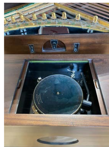
Beim „Neo-Bechstein“ aus dem Jahr 1932 verstärken elektrische Röhren den Klang, der dann über eine Lautsprecher-Box ausgestrahlt wird. In dem angeschlossenen Phono-Möbel fand noch ein Schellack-Plattenspieler Platz.
