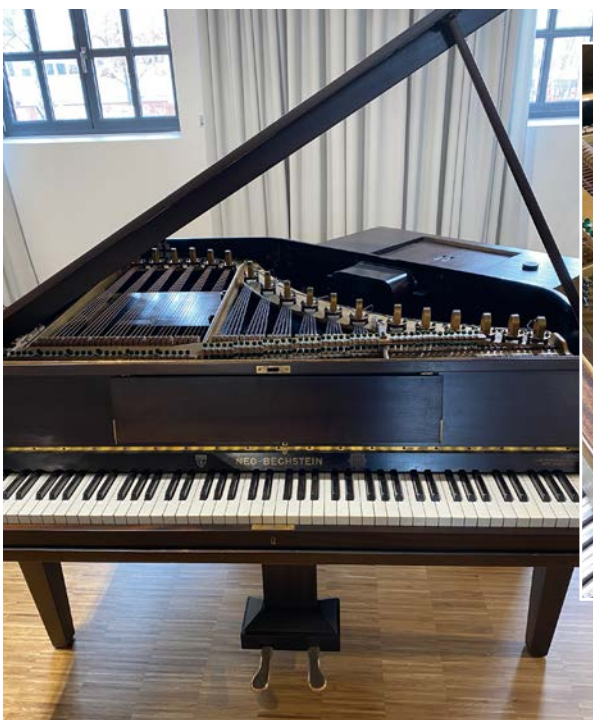
Beim „Neo-Bechstein“ aus dem Jahr 1932 verstärken elektrische Röhren den Klang, der dann über eine Lautsprecher-Box ausgestrahlt wird. In dem angeschlossenen Phono-Möbel fand noch ein Schellack-Plattenspieler Platz.
