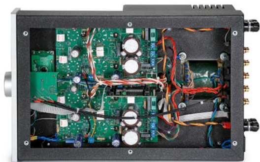
Die spiegelsymmetrische Platine des Aeolos Ultra ist an einigen Stellen gegenüber der kleineren „Plus“-Version mit höherwertigen Teilen bestückt.
