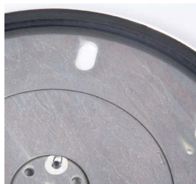
Der dünne, leichte Aluminiumteller wird durch einen Gummiring auf seiner Innenseite bedämpft und so vor dem Resonieren geschützt.
