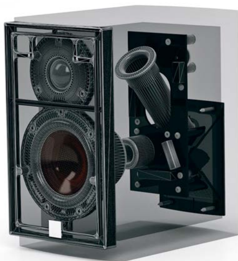
Der Blick ins Innere zeigt den Aufbau und das hinter dem Terminal gebogene Reflexrohr.
