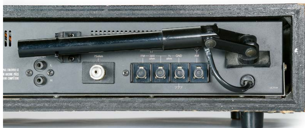
Die Ferritantenne für Mittelwelle (AM) ist heute unnütz, das „Sendeformat“ war aber in den 70ern noch recht beliebt. Haben wir als Kinder auch gehört.
