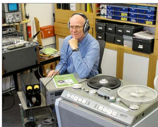
Mit der legendären „Beatles-Studer“ C37 erstellt Burkhardt Schwäbe Masterbänder von digitalen Quellen, die auf diese Weise einen charakteristischen Analog-Touch erhalten.
