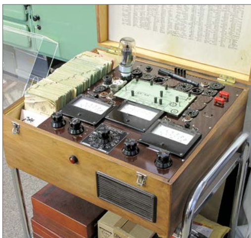
Aus dem Jahre 1954 stammt dieses Röhrenprüfgerät Funke W20, mit dessen Hilfe sich die Kennlinien unterschiedlichster Glühlampen auch heute noch präzise darstellen lassen.
