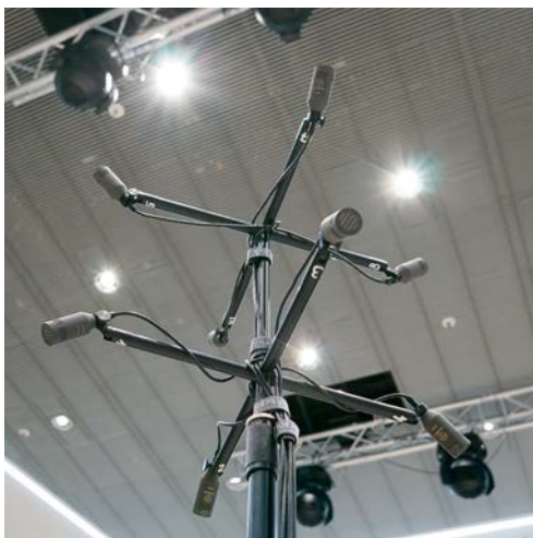
Als Hauptmikrofon fungiert ein „Geweih“ bestehend aus je vier Mikrofonen auf zwei Ebenen.
