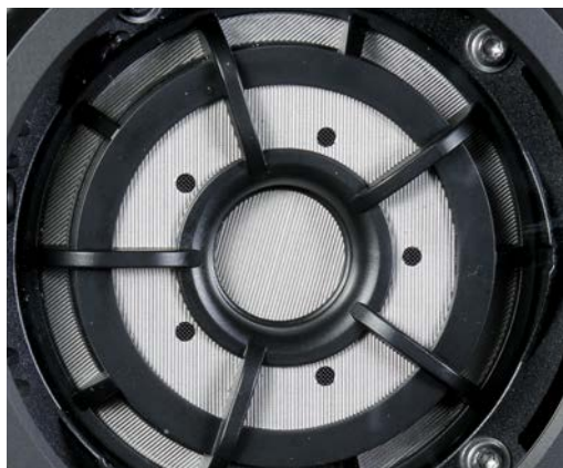
Hinter einer Glasscheibe zeigt sich der 56 Millimeter große Treiber.
