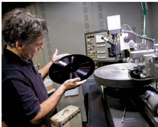
Marten de Boer überprüft das Rillenprofil der geschnittenen Lackfolie, denn Unsauberkeiten würden sich auf die Pressung der Platten auswirken.
