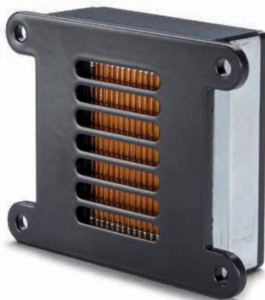
Der JET-Hochtöner arbeitet nach dem Air-Motion-Prinzip und erzeugt Schall über eine gefaltete Flachmembran.
