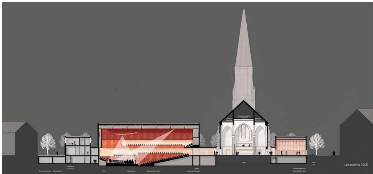
Das Anneliese Brost Musikforum Ruhr im Schnitt: links der Konzertsaal, in der Mitte die als Foyer fungierende Marienkirche, rechts der kleine Saal
