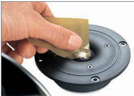
Mit Klebeband lässt sich eine verformte Gewebekalotte oft wieder in Form bringen.
