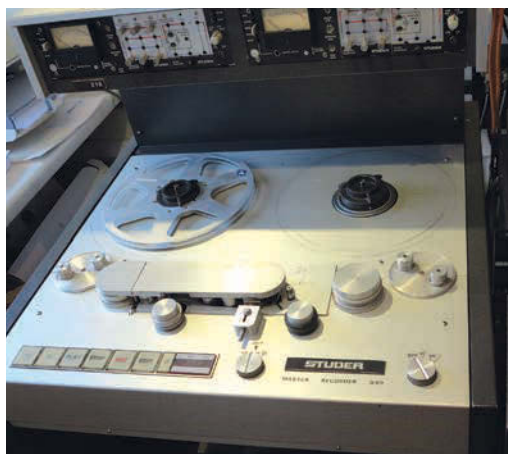
Die historischen Bänder spielte man beim Prozess der Digitalisierung mit einer Studer A-80-Bandmaschine ab.
