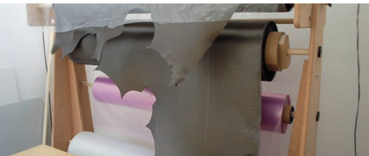
Ähnlich wie Geschenkpapier aus dem Bastelladen werden die Carbonmatten auf Walzen aufgerollt.
