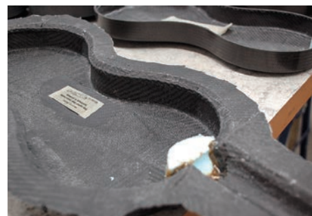
Da eine Lage Carbon zu dünn wäre, werden mehrere Lagen übereinander geschichtet. Die Carbonschichten werden mit Harz getränkt und 24 Stunden lang unter Vakuum in eine Form gepresst (Bild links). Decken (Bild Mitte) und Böden (rechts) der Geige werden separat gefertigt und dann zusammengefügt. Das Bild in der Mitte zeigt die noch unlackierten Korpusse der Carbongeigen.
