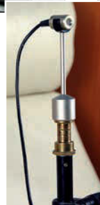
Mit einem am Hörplatz platzierten Messmikrofon (rechts), das an einen Neutrik Analyzer 3300 (oben) angeschlossen ist, lassen sich Frequenzgänge, Phasen, Nachhallzeiten messen; die Ergebnisse werten wir aus (ganz rechts).
