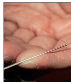
Nicholas Baldock, der Herr der Saiten: In seiner Werkstatt im Taunus stellt er aus vorbehandelten Schafsdärmen seine bei Musikern begehrte Ware her. Mehrfach gedreht, müssen die Saiten getrocknet und mit Gewichten beschwert werden, damit sie nicht zu elastisch werden.
