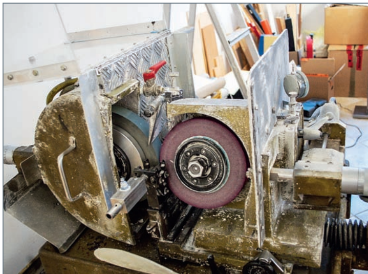
Mehrere Arbeitsschritte sind vonnöten, um aus einem aufgeschnittenen Schafsdarm eine musizieraugliche Saite herzustellen. Den Feinschliff des fertigen Produkts besorgt schließlich eine spezielle Schleifmaschine.
