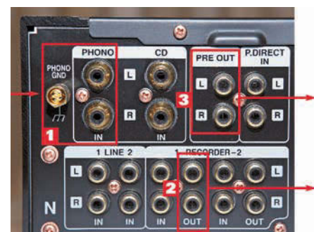
Wenn Sie keinen separaten Phono-Vorverstärker besitzen, können Sie den Entzerrer des Vollverstärkers (1) verwenden. Verbinden Sie den PC einfach mit einem der Rec-Ausgänge (2).
