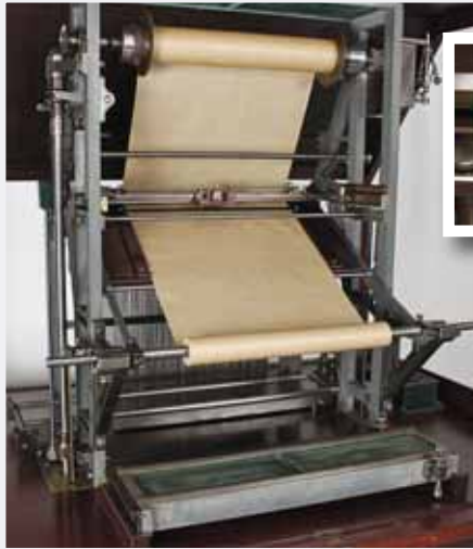
Das technische System der Britannic-Orgel gilt bis heute als Sensation. Als Tonträger fungieren Lochstreifen aus Papier, die von einer Rolle abgespielt werden – ähnlich den Stiftwalzen einer Spieldose.
