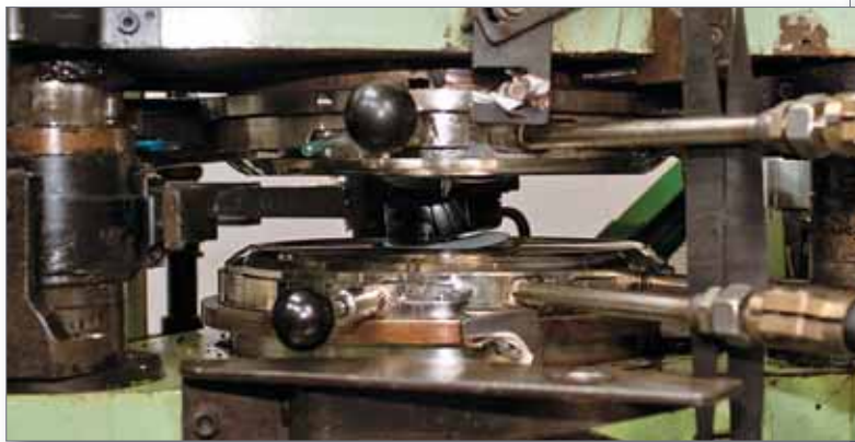
Der Schneidkopf Vinylum SC 99 schneidet in eine Lackfolie, eine „Urschallplatte“ wird fabriziert (rechts). Sekunden später entsteht hier eine Schallplatte: der Massekuchen, eingeschlossen zwischen zwei Pressmatrizen (oben).
