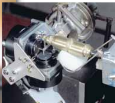
Ganz links: Der von Dr. Corinth entwickelte Schneidkopf HLX (Ansicht von unten).
