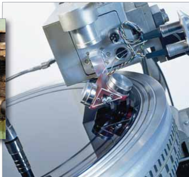
Der Schneidkopf Vinylum SC 99 schneidet in eine Lackfolie, eine „Urschallplatte“ wird fabriziert (rechts). Sekunden später entsteht hier eine Schallplatte: der Massekuchen, eingeschlossen zwischen zwei Pressmatrizen (oben).
