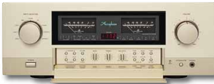
Der E-460 versteckt einen Großteil seiner Ausstattung hinter einer Klappe, unter anderem Ton- und Balanceregler, eine Mono-Taste, den MC- und MM-Umschalter für den Plattenspieler und vieles mehr (links). Der Accuphase-Verstärker glänzt mit einer Vielzahl von Anschlüssen (rechts).
